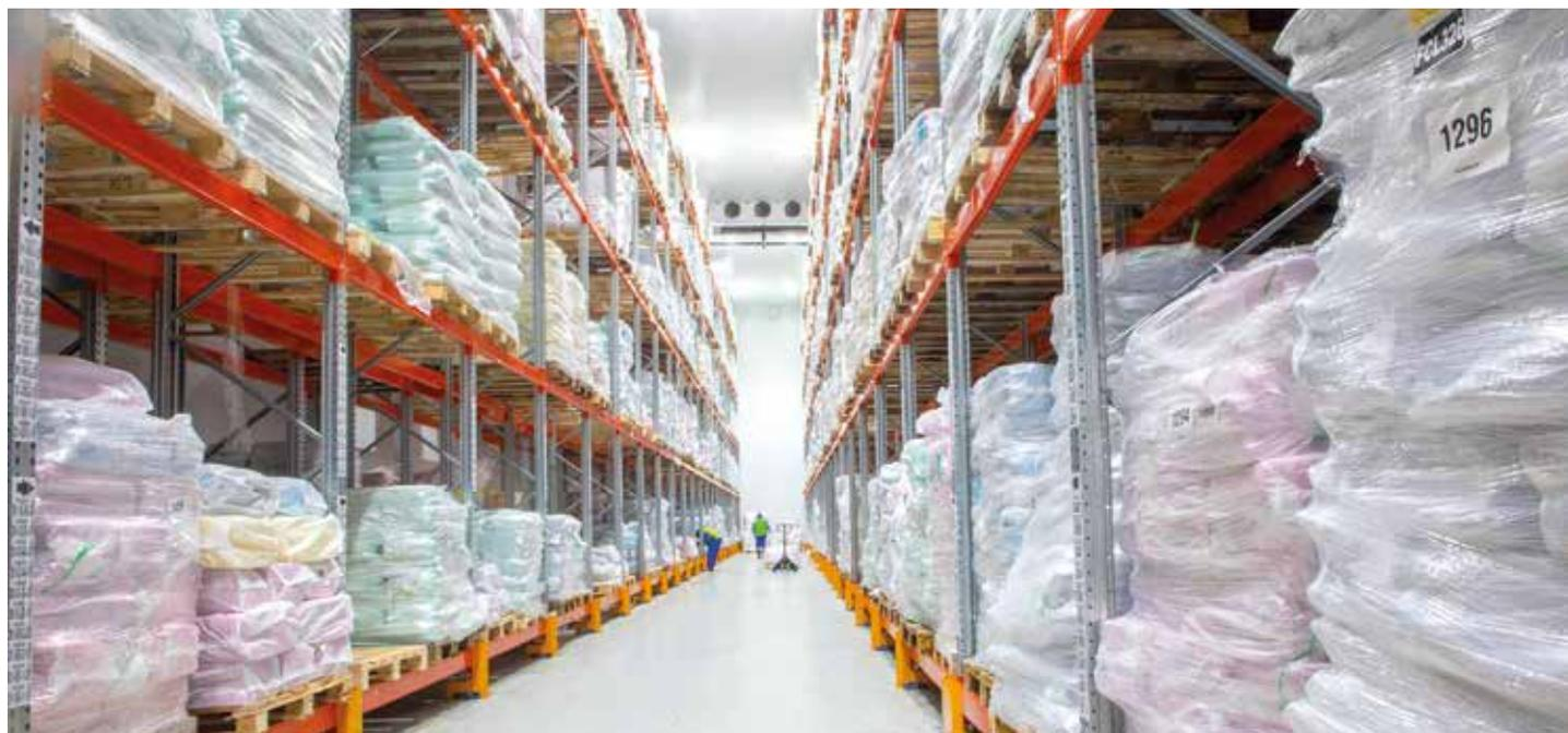
AR Racking instalado estanterías de doble profundidad sismorresistentes en cinco cámaras de frío dando como resultado 7.285 posiciones.
